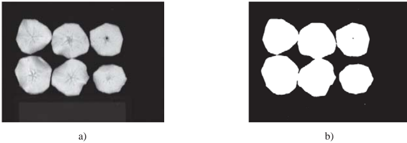
Rys 1. Wyodrębnienie obszarów obrazu odpowiadających suszonym owocom a) przykładowy obraz dla długości fali \lambda=864 nm, b) maska binarna po odfiltrowaniu tła i szarej karty Źródło: Opracowanie własne.
